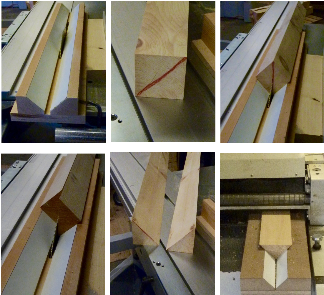
Abbildung 12: In der speziellen Lehre (oben links) liegen die quadratischen Holzstäbe (oben Mitte) auf der Kante (oben rechts). Bei grösseren Querschnitten sind zwei Schnitte mit der Kreissäge nötig, der Stab wird nach dem ersten Schnitt gewendet (unten links). Im Anschluss ans Aufsägen, wird die gesägte Fläche gehobelt (unten rechts).
