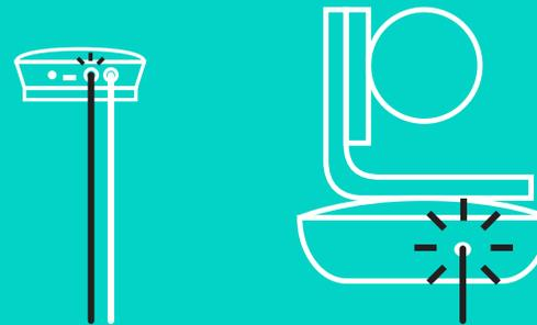
Wenn Sie die optionalen Erweiterungsmikrofone verwenden, verbinden Sie sie mit den entsprechenden Buchsen auf der Unterseite der Freisprecheinrichtung. Verwenden Sie nur diese Mikrofone mit GROUP. Die Verwendung anderer Mikrofone kann zu Schäden an GROUP und zum Erlöschen der Garantie führen.
