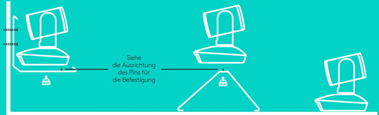
2. Der Hub kann auf dem Tisch oder darunter aufgestellt werden, wenn Sie hierfür die im Lieferumfang enthaltenen Befestigungen und Klettschlüsse verwenden.
