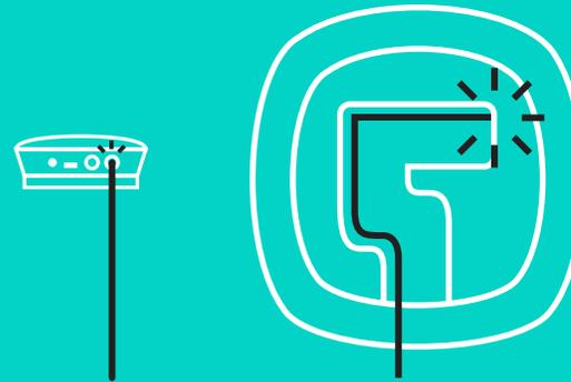
Verbinden Sie das Kabel zwischen der Kamera und dem Hub. Vergleichen Sie einfach die farbigen Kabelenden mit den entsprechend gefärbten Markierungen auf der Kamera und dem Hub.
